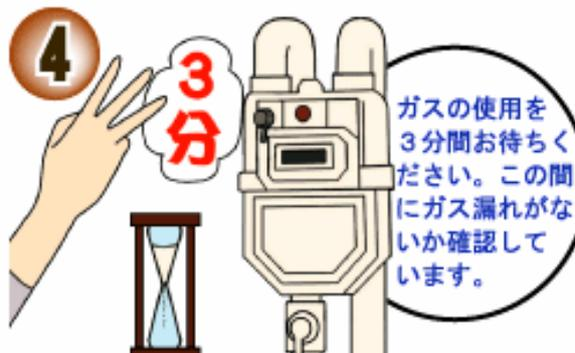
約3分待つ。3分経過後に、再度ガスメーターをご確認いただき、赤ランプの点滅が消えていれば、ガスが使えます。（ガスの使用を3分間お待ちください。この間にガス漏れがないか確認しています。）
