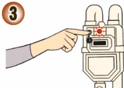
復帰ボタンを奥までしっかり押して手をはなす。（一瞬赤ランプが点灯します。ボタンは元に戻り、赤ランプは再び点滅）→（キャップを元に戻す）
